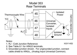
FIGURE 8-16 Universal Analog Input AINU1, Thermocouple Input
