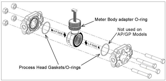
Figure 24 – Meter Body Reassembly
